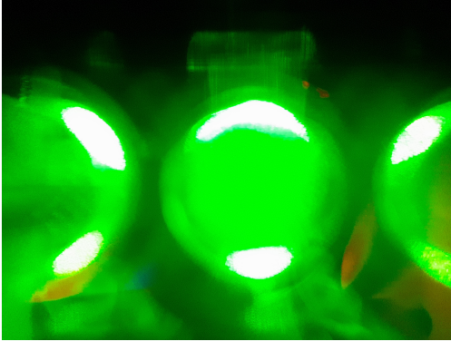
Abbildung 3.4: Aufnahme des Smartphones, nachdem alle Schritte der Kalibrierung vollzo- gen waren. Man beachte, dass das Gitter vor der Smartphone-Kameralinse eine Aufspaltung des Lichts verursachen sollte, diese Aufspaltung allerdings nur minimal in der Verdopplung der Linse erkennbar wird.
